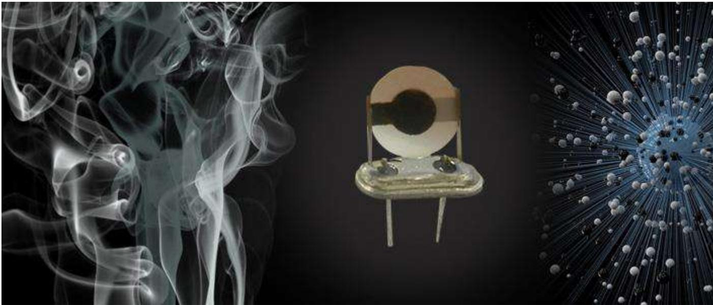
“Lo que hacemos es detectar las moléculas en estado gaseoso por medio de sensores. Estos sensores no son otra cosa que una película sensible adherida a un transductor que genera un fenómeno físico o químico. Y ese es el principio que nosotros utilizamos para detectar olores”, informó en entrevista para la Agencia Informativa Conacyt el doctor Severino Muñoz Aguirre, quien encabeza el proyecto.
